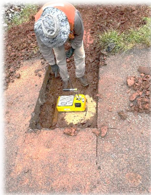
Figura 15 y 16: Destape y medición de densidades. Calicata N°3.
