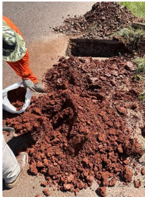
Figura 13 y 14: toma de muestras para ensayos de laboratorio. Calicata N°2.
