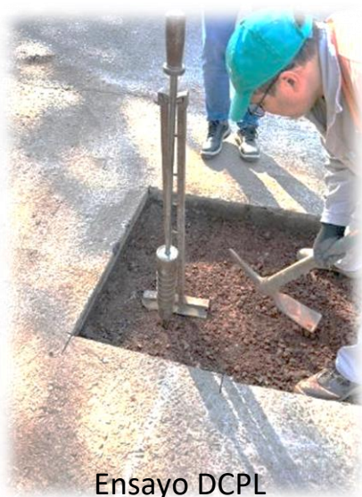
Figura 5 y 6: Ensayo DCPL y medición de densidad con Densímetro Nuclear.
