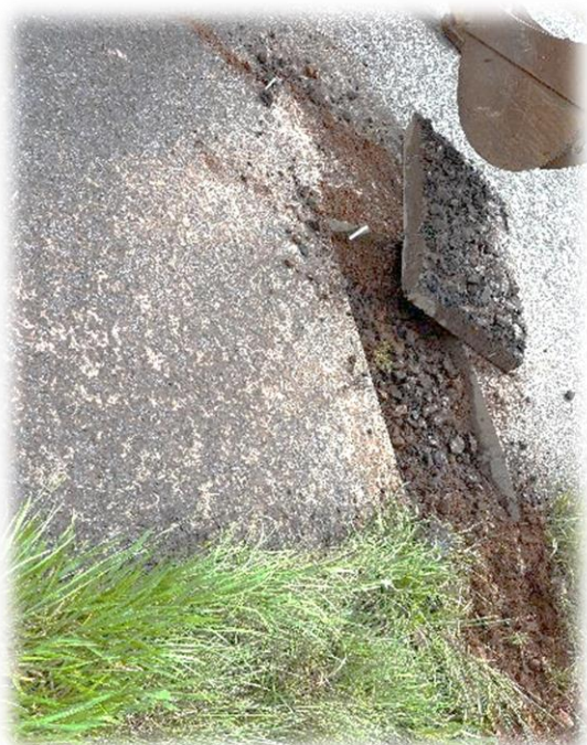
Figura 15 y 16: Destape y medición de densidades. Calicata N°3.
