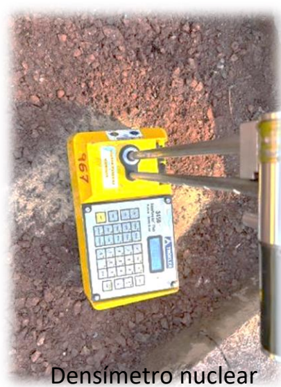
Figura 5 y 6: Ensayo DCPL y medición de densidad con Densímetro Nuclear.
